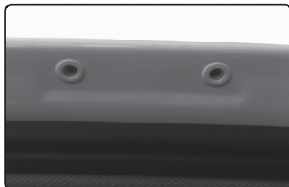
V rámu karoserie nad dveřmi jsou závity určené pro zafixování bočních úchytnů.
