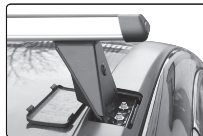
Ukázka namontovaného střešního nosiče. Víčka střešní lišty pečlivě uschovejte.
