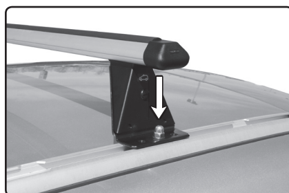
Na střeše vozidla je T - profil určený pro zafixování střešního nosiče.
